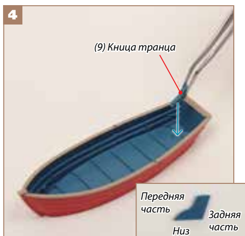
4 В вырез в днище вставьте кницу (9) и закрепите секундным клеем.
